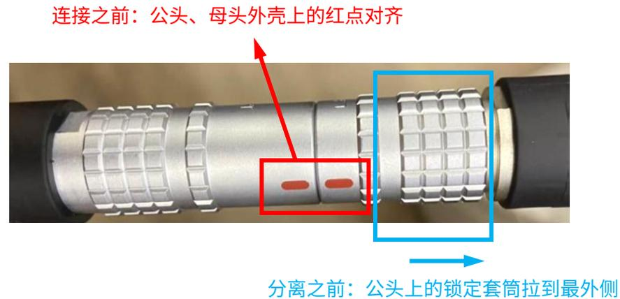
图 2.6 连接/分离 Lemo 连接器
